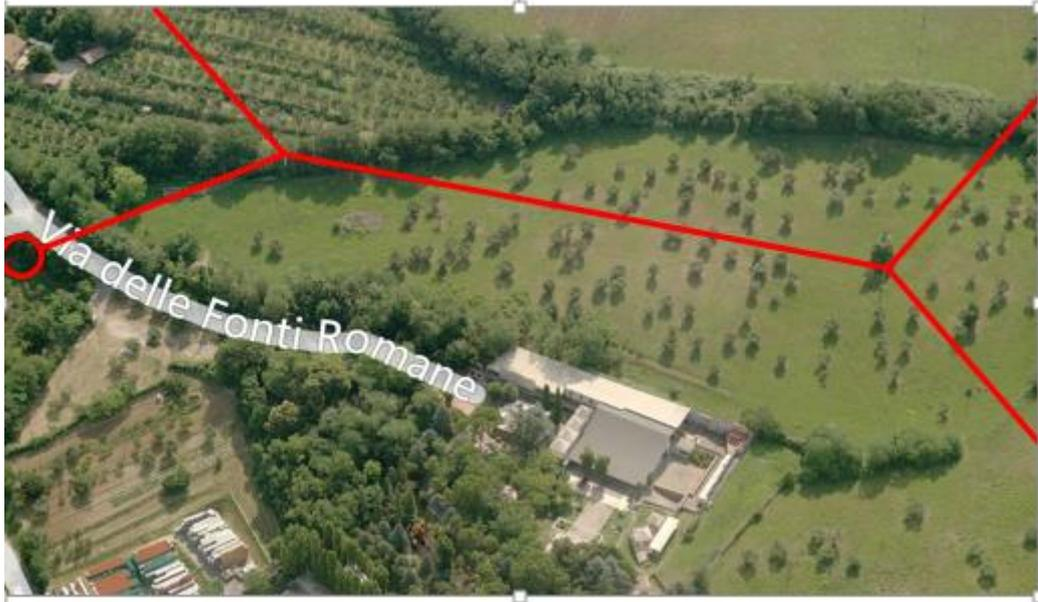
Figura 2: Elettrodotto MT in cavo aereo che attraversa i campi di proprietà della Galvanina
